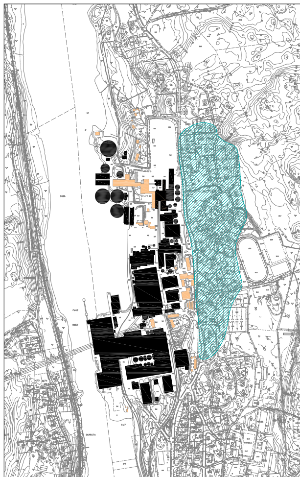
Figur 5. Med en förhärskande västlig vind är bebyggelsen öster om bruket utsatt för en betydande miljöpåverkan genom den vattenånga som kommer från bruket. Ångan är i sig inte skadlig för hälsan men är inte förenlig med en god boendemiljö. Efter MKB-utredningen Structor
